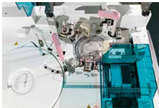
FIG. C In der klinischen Chemie verteilt ein Automat die Blutprobe auf kleine Rotorblätter und bestimmt ihre chemischen Bestandteile.
