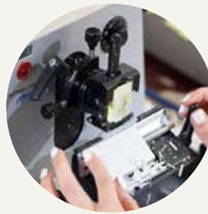
FIG. C Mit einem speziellen Schneidegerät, dem Mikrotom, lassen sich von diesen Blöcken hauchzarte Schnittpräparate abnehmen. Anschließend werden sie auf Glasträger aufgezogen.
